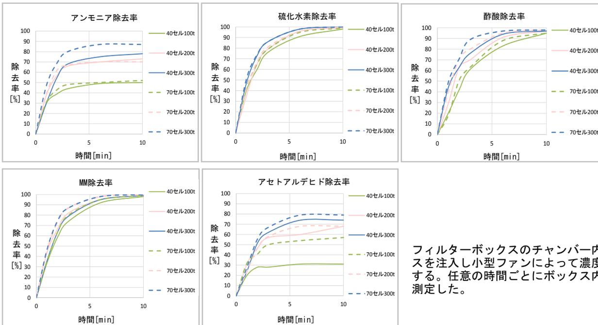
フィルターボックスのチャンバー内に悪臭ガスを注入し小型ファンによって濃度を均一化する。任意の時間ごとにボックス内の濃度を測定した。
